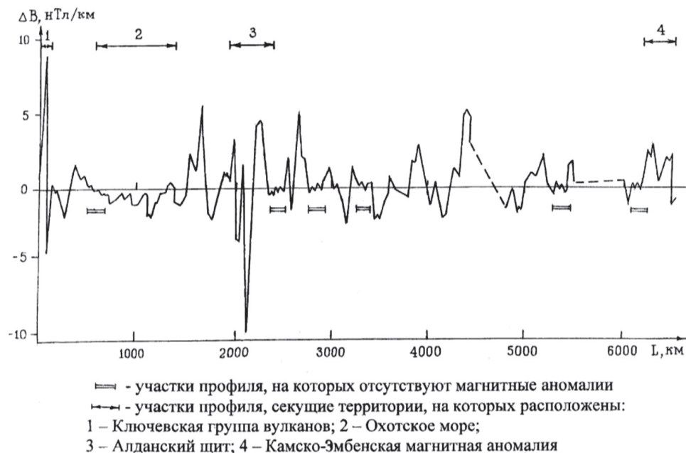
Рис. 7. Вертикальный градиент аномального магнитного поля на высоте h = 30 км вдоль трассы полёта аэростата [Цветков и др., 2011a]
