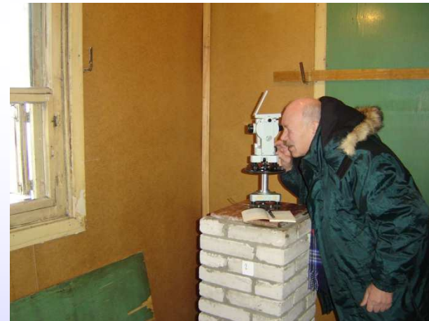
Сверка буссоли «Востсибнефтегаз» (2009 г.)
