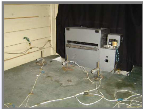
Кварцевые вариометры Боброва с фотозаписью (датчики и регистратор)
