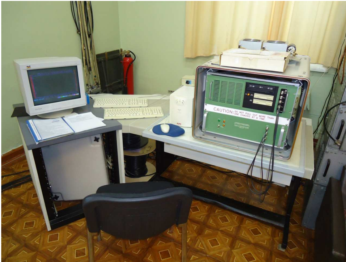
Регистрация параметров ионосферы осуществляется дигизондом DPS-4
