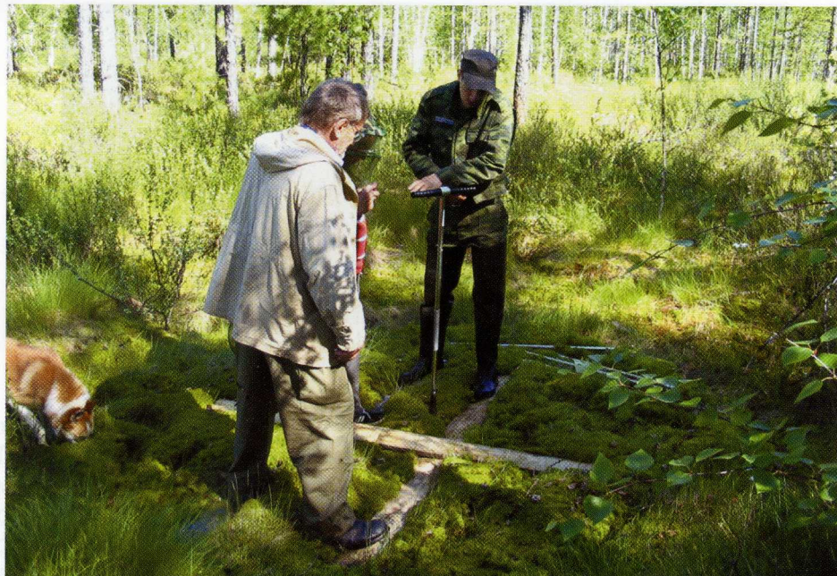
Рис 19. Ручное бурение воронки.
