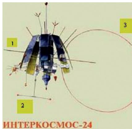
**Рис. 1.** ИСЗ «Интеркосмос-24»: 1 — антенна прибора для возбуждения плазмы (ПВП); 2 — двойной зонд для измерения компоненты поля  $E_x$  с помощью прибора НВК-ОНЧ; 3 — круговая магнитная антенна
