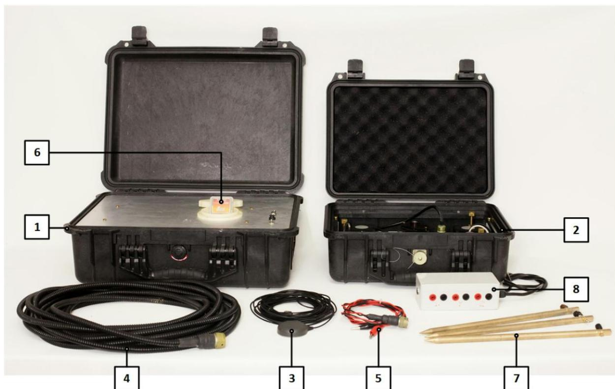
Рис.1. Геофизическая станция GI-MTS-1. 1 – Регистратор. 2 – Магнитометр. 3 – GPS-антенна. 4 – Кабель связи. 5 – Кабель питания. 6 – Карта памяти. 7 – Электроды.
